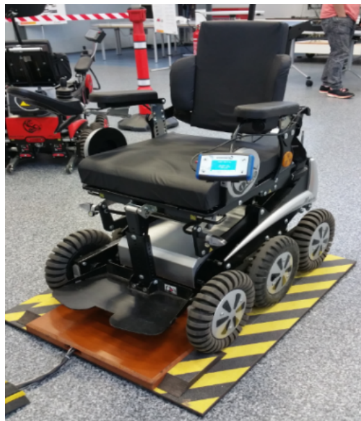
Figure 1: Fauteuil électrique sur la plateforme de recharge par induction
