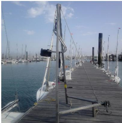
Grâce à un treuil latéral, la PMR est soulevée depuis son fauteuil, le portique bascule jusqu'au-dessus de l'embarcation, et la PMR peut alors être descendue pour l'asseoir dans le bateau.
