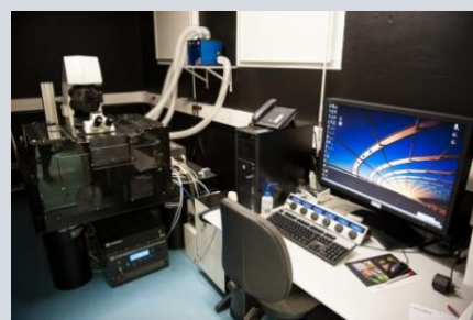
Système sp8 Leica au sein des installations expérimentales IERP, dédié à l'imagerie de processus dynamiques en poissons zèbres.
