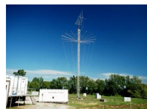
Antenne large bande pour tests électromagnétiques
