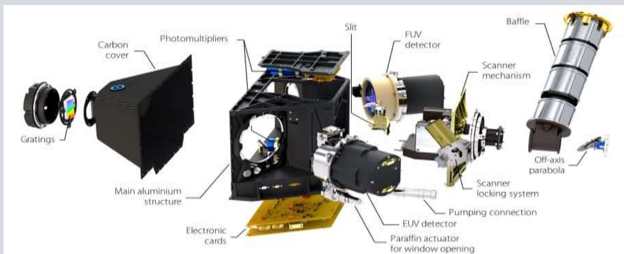
Vue éclatée des principaux sous-systèmes de PHEBUS. Crédits: équipe PHEBUS/ LATMOS
