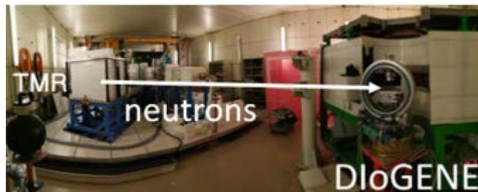
A droite : l'instrument de diffusion de neutrons DioGENE, installé dans la casemate expérimentale de l'accélérateur IPHI (au fond de l'image). Sur la partie gauche de l'image, on voit une vue d'ensemble du TMR - Target Moderator Reflector, contenant la cible Be. L'échantillon est placé au milieu du berceau d'Euler devant le diffractomètre Diogène.
