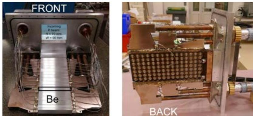
Vue avant et arrière de la cible de haute puissance.
