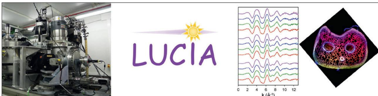
LUCIA est l'une des lignes de lumière du synchrotron SOLEIL. Elle se caractérise par la production d'un microfaisceau dans la gamme d'énergie 0.8-8 keV.
