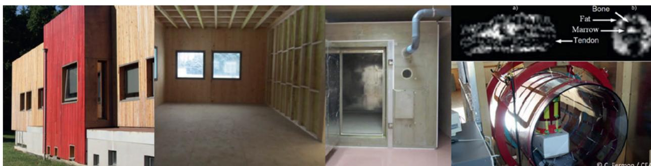
La plateforme Ultra Bas Bruit Magnétique (UBM) offre différents outils pour la caractérisation de capteurs magnétiques ou d'antennes basses fréquences comprenant entre autre une chambre magnétiquement blindée avec un bruit inférieur au femtoTesla par racine de Hz.
