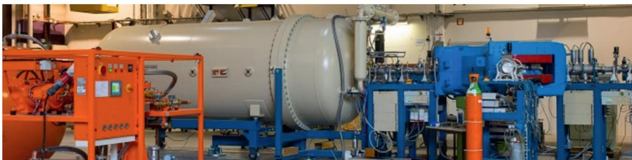
Andromède est au centre d'une collaboration pluridisciplinaire de l'Université Paris-Saclay qui propose un nouvel instrument pour modifier et analyser toutes les surfaces solides en utilisant l'impact d'hydrogène jusqu'à celui de nanoparticules dans le domaine d'énergie du MeV. Installé en juillet 2015 à SuperAco, l'accélérateur (un pelletron de 4 MV) est opérationnel depuis novembre 2016 après avoir obtenu l'approbation de l'ASN. Andromède est une plateforme labellisée IN2P3 depuis 2017.
