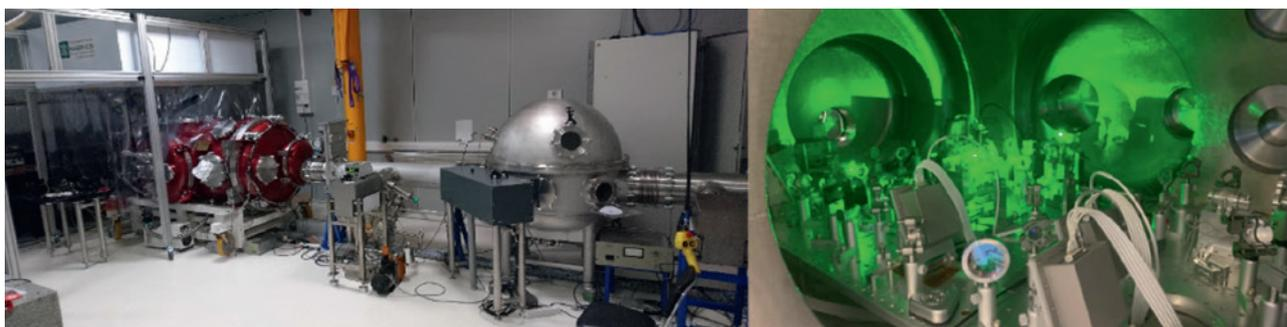
CALVA est une plateforme expérimentale comprenant des cavités optiques suspendues. Cette expérience permet de tester de nouvelles techniques dites d'états comprimés de la lumière pour améliorer la sensibilité des interféromètres kilométriques Virgo et LIGO dédiés à la recherche des ondes gravitationnelles prévues par la théorie de la Relativité Générale d'Einstein.
