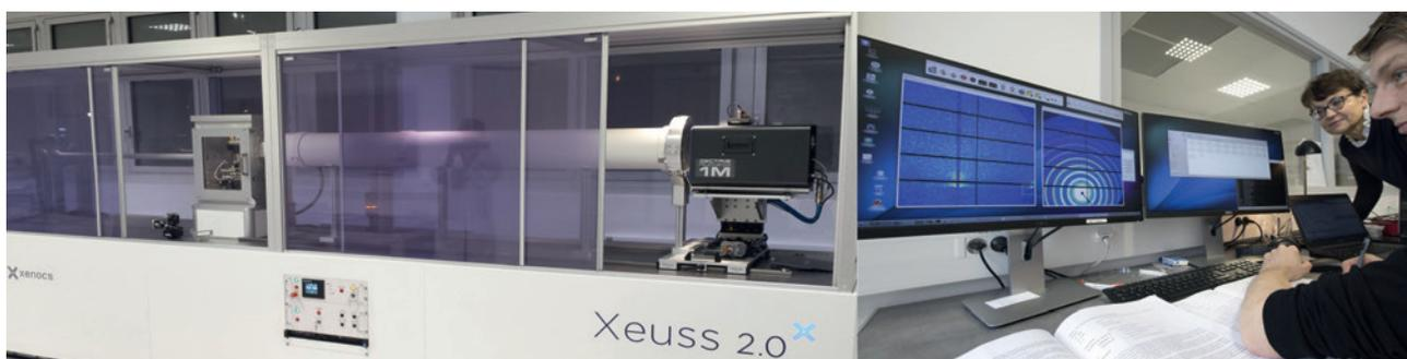
The LLB a installé dans le « SWAXSLab » du CEA Saclay un spectromètre de diffusion de rayons X haute résolution, un Xeuss 2.0 de la compagnie Xenocs.
