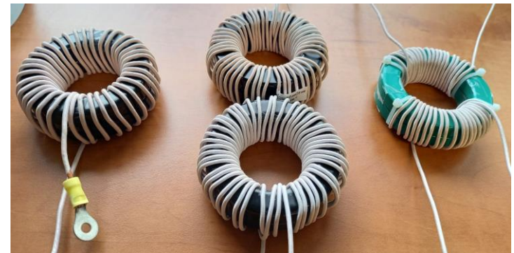
A droite, coupleur magnétique nanocristallin plus léger et avec moins de perte
